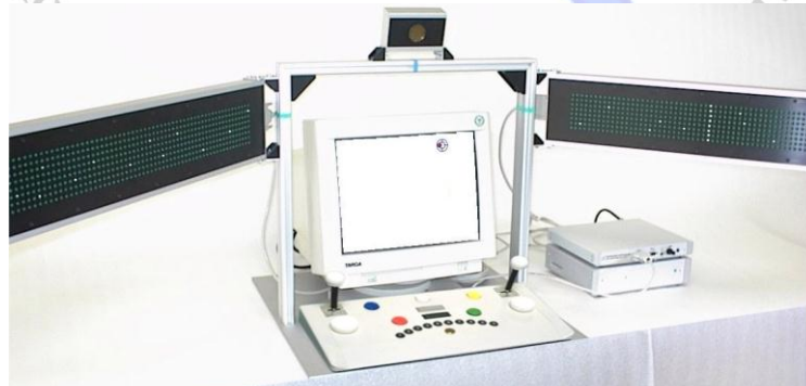
الشكل (4) يوضح الإعداد والوضع الصحيح لجهاز إدراك المحيط.
